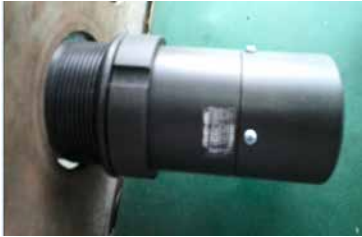
③把测距传感器对准法兰孔
